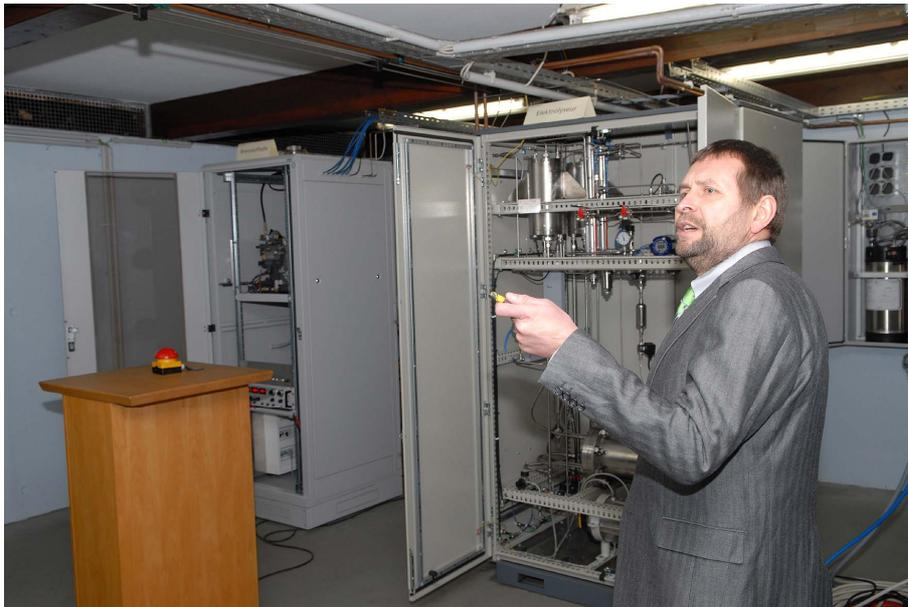
Als Verantwortlicher für den Aufbau der Forschungsanlage erklärte Hans Holtorf (Universität Oldenburg) die installierten Komponenten und das Zusammenwirken im System. Die Anlage verfügt unter anderem über einen Elektrolyseur mit Leistung von 5 Kilowatt zur Gewinnung von Wasserstoff (Mitte) und einer Brennstoffzelle mit 1,2 Kilowatt Leistung zur Rückverstromung (links).
